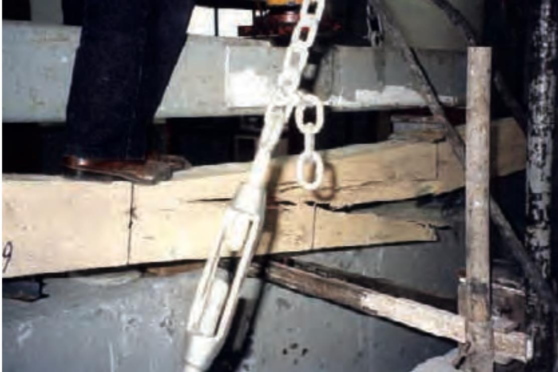
Prova a rottura di una trave fuori cuore con accentuata deviazione della fibratura. Nelle travi fuori cuore la deviazione è decisamente pericolosa per inclinazioni >10%
